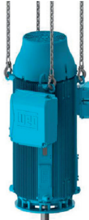
Figura 4.9 - Elevación de motores HGF y W50
