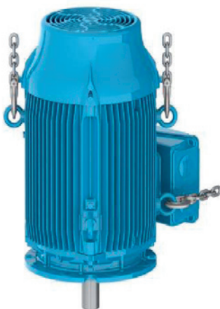
Figura 4.12 - Resultado final: motor posicionado na vertical
