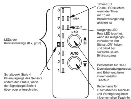
Abbildung 3. Bedientasten und LEDs für die Statusanzeige
