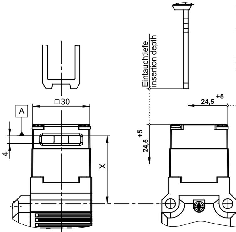
Zur Montage an der Maschine müssen Sicherheitsschalter (mit Einführtrichter) und Betätiger zusammengefügt sein.
