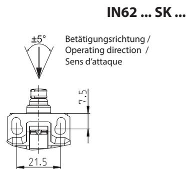
Fixierte Positionierung z.B. mit Befestigungsschraube M5 nach DIN EN ISO 4762. / Fixed positioning with e.g. fixing screw M5 according to the standard DIN EN ISO 4762. / Un positionnement fixe s'effectue au moyen d'une vis de fixation M5 (p.ex.) selon DIN EN ISO 4762.
