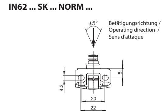
Gehäuse mit Anschlußlöchern nach DIN EN 50047 / Switch housing with mounting holes according to DIN EN 50047 / Boîtier avec trous de fixation selon DIN EN 50047
